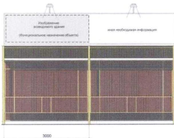
Информационный щит строительного объекта располагается над строительным ограждением.
