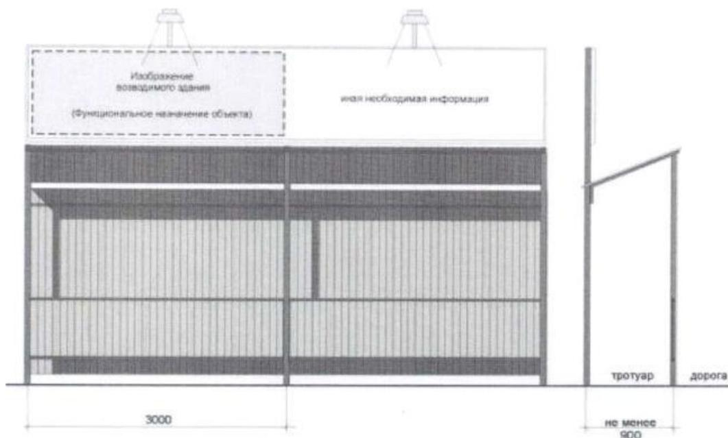
Информационный щит строительного объекта располагается над строительным ограждением.
