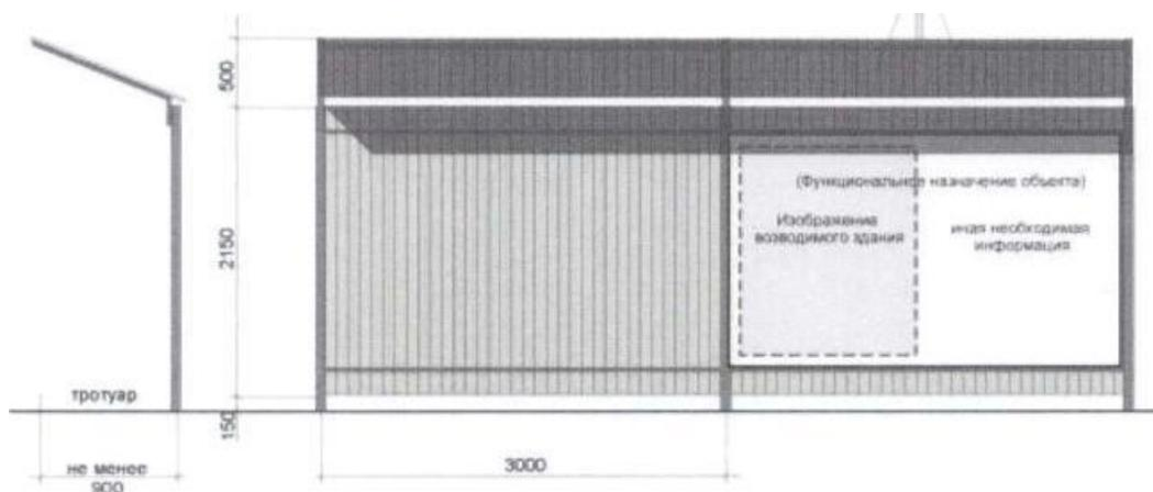
Тип 1.2. Строительное ограждение с навесом и защитным ограждением
